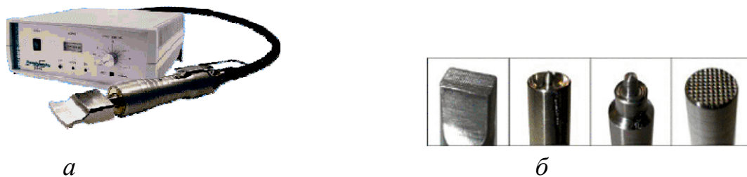
Рис.7.21. Ручной инструмент для сварки «Handy Star» (а) и волноводы с различной рабочей поверхностью (б)
